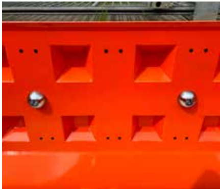
1 Posizionare il magnete al centro dello stampo
