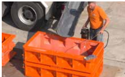
2 Applicazione del disarmante nello stampo
