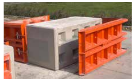
9 Blocco di calcestruzzo pronto
