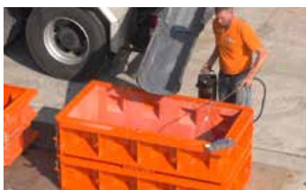
2 Application de l'huile dans le moule.
