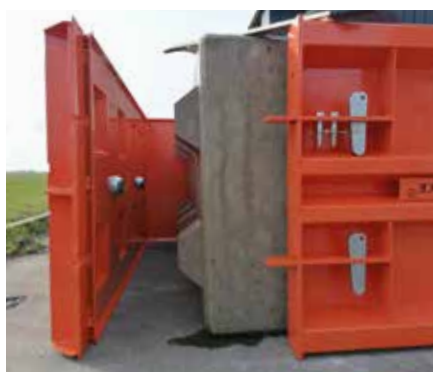
4 Lorsque le moule est ouvert, le sphère magnétique reste dans le moule
