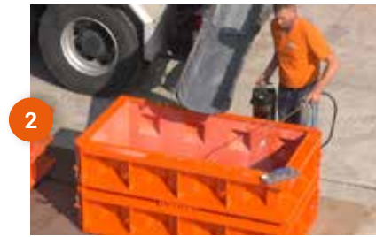
Application de l'huile dans le moule
