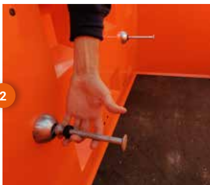
Placez le caoutchouc (BBGR002) autour de l'ancrage (BBHA025)
