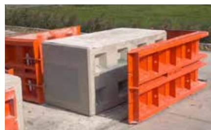
9 Bloc de béton prêt.
