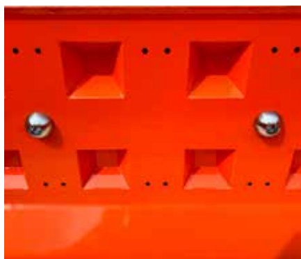
1 Placez le sphère magnétique (BBMAG02) au milieu du moule
