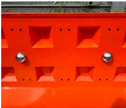
1 Coloque la base magnética en el centro del molde
