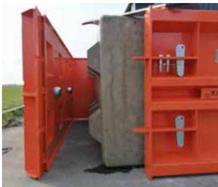
4 Cuando se abre el molde, el imán permanece en el molde
