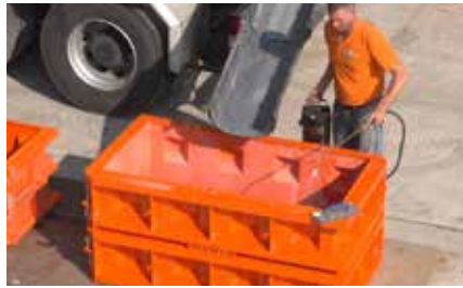
2 Die Anwendung von Öl in der Betonblock Forme
